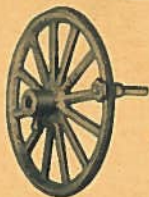
69 Ruota a razze con manicotto e vite di calettamento
