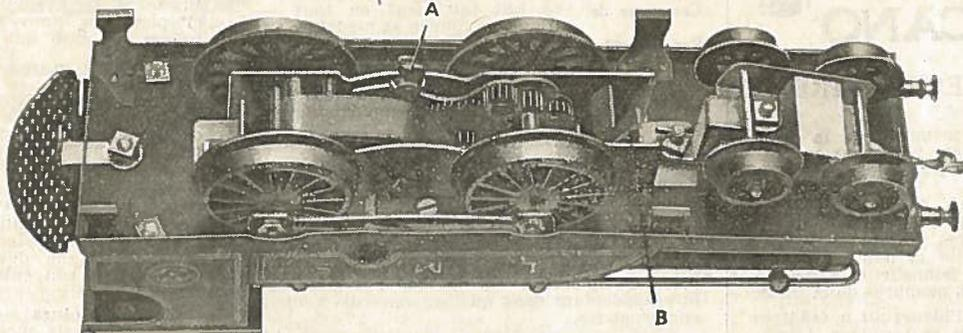
Fig. 1. Dessous d'une Locomotive Hornby N° 2
