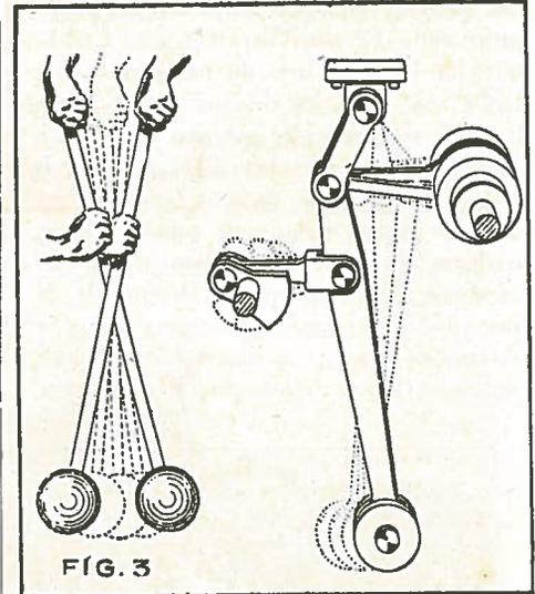
qui se traduit au convertisseur par un mouvement pendulaire de grande amplitude du levier à masse. Dans ce mouvement lent nous remarquons que nous n'éprouvons pas de difficulté à tenir notre main droite immobile.
