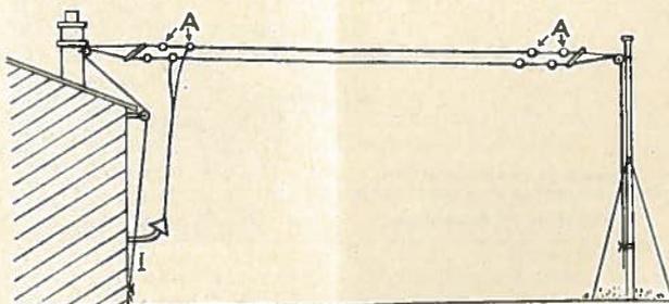
Fig. 2. — Antenne à double fil.
