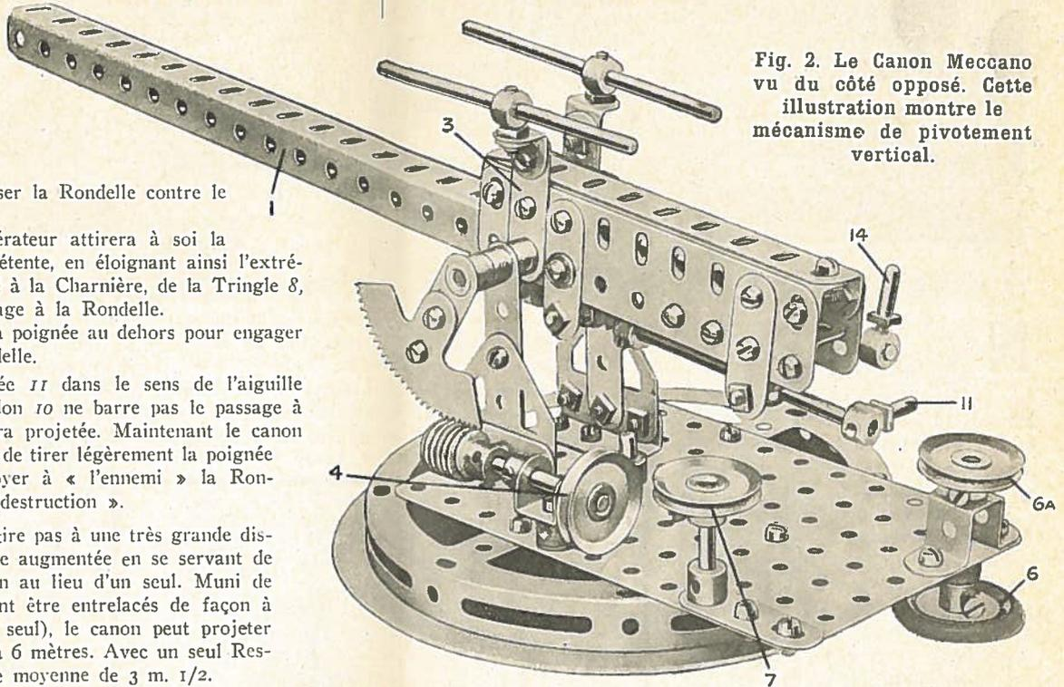
Fig. 2. Le Canon Meccano vu du côté opposé. Cette illustration montre le mécanisme de pivotement vertical.
