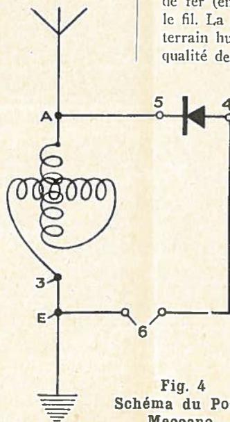
Fig. 4. Schéma du Poste Meccano.
