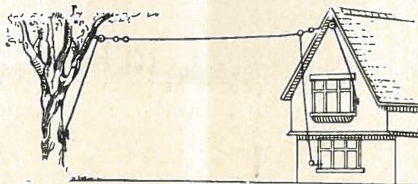
Fig. 1. — Antenne typique à un seul fil.
