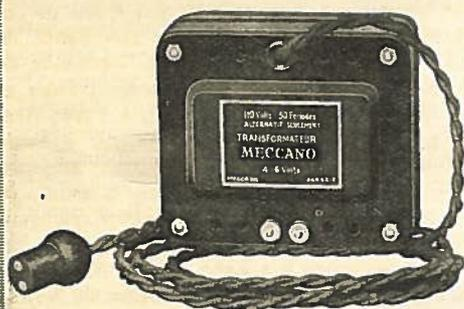
Le transformateur Meccano a été établi pour transformer un courant de 110 volts (alternatif seulement) en courant de 4-6 volts. Ce transformateur est spécialement recommandé pour être adapté au moteur électrique Meccano 4 volts et aux Trains Electriques Hornby. Sa construction, simple et robuste, évite tout danger et supprime toute vibration et possibilité de court-circuit.
