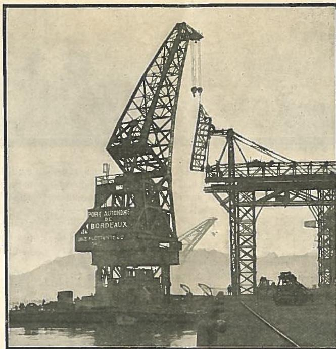
Grue flottante automotrice de 30 tonnes de puissance
