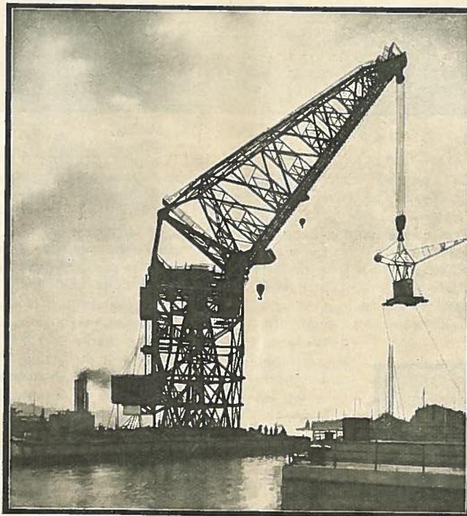
Grue Flottante de 150 tonnes (Etab<sup>l</sup> Demag)
