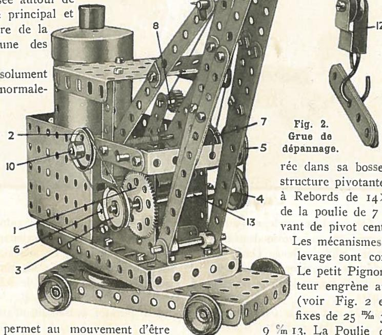
Les mécanismes de relevage de la flèche et de levage sont constitués de la façon suivante. Le petit Pignon de la tige de l'induit du Moteur engrène avec une Roue de 57 dents 1 (voir Fig. 2 et 4) et actionne les Poulies fixes de 25<sup>m</sup> 3 et 4 situées sur la Tringle de 9<sup>m</sup> 13. La Poulie de 25<sup>m</sup> 3 est reliée par une
