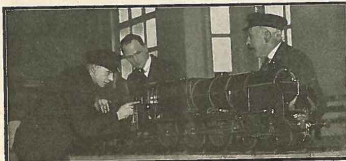
Ce modèle en miniature de la fameuse loco anglaise « Lord Nelson » mesure 2 mètres de long environ et peut traîner 2 tonnes à une vitesse de 20 kilomètres à l'heure.
